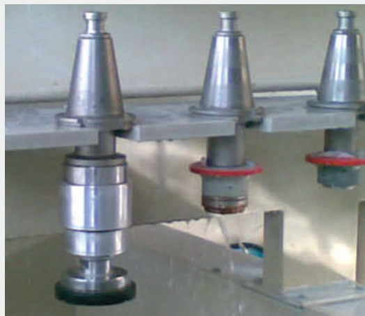
Giunto di compensazione per lucidare piani top cucina Compensating joint for polishing kitchen worktops
