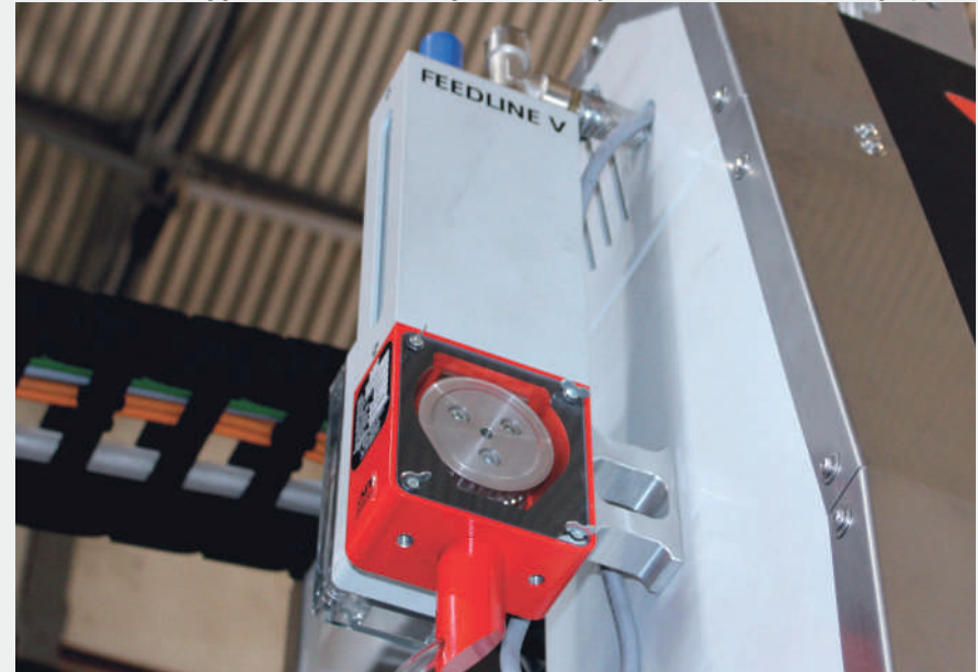
Sistema di dosaggio dell'abrasivo regolabile - Adjustable abrasive dosing system
