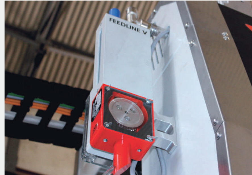
Sistema di dosaggio dell'abrasivo - Abrasive dosing system
