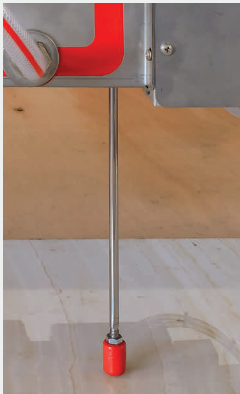
Tastatore lastra - Slab touch probe
